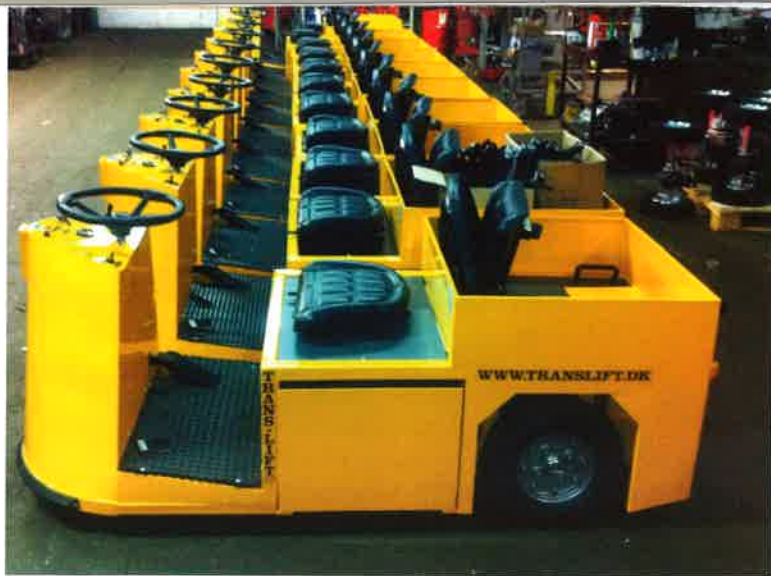
Trans-LIFT har lavet 15 specialfremstillede elvogne til CERN's 27 km lange acceleratortunnel.
